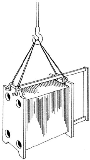
Строповка теплообменника с транспортировочными отверстиями
