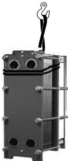
Строповка теплообменника без транспортировочных отверстий
