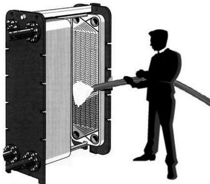
**Рисунок В.1 – Схема очистки теплообменника водой под давлением и щеткой**
