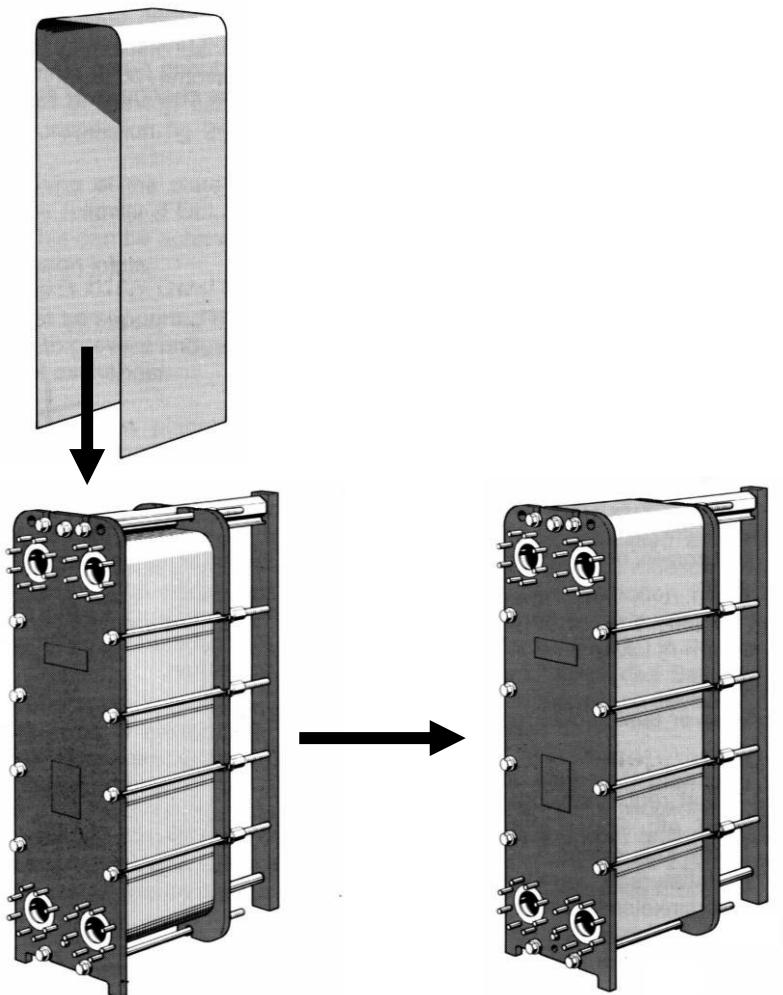
**Рисунок А.5 – Схема установки защитного экрана**
