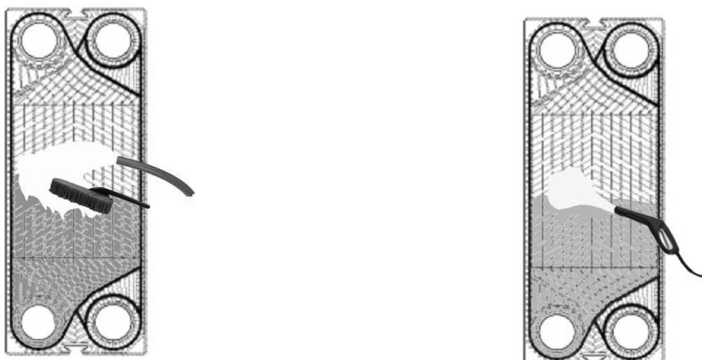
**Рисунок В.2 – Схема очистки теплообменника моющей жидкостью и щеткой**
