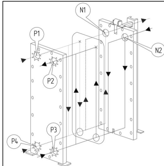
P1 – вход горячего теплоносителя из тепловой сети;
