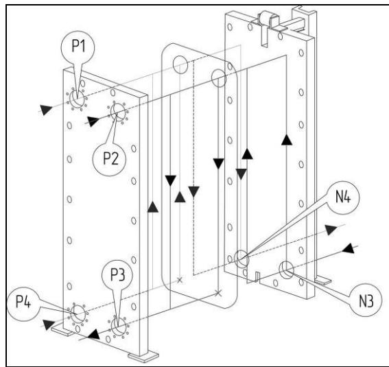
P1 – вход обратного теплоносителя из системы отопления;
